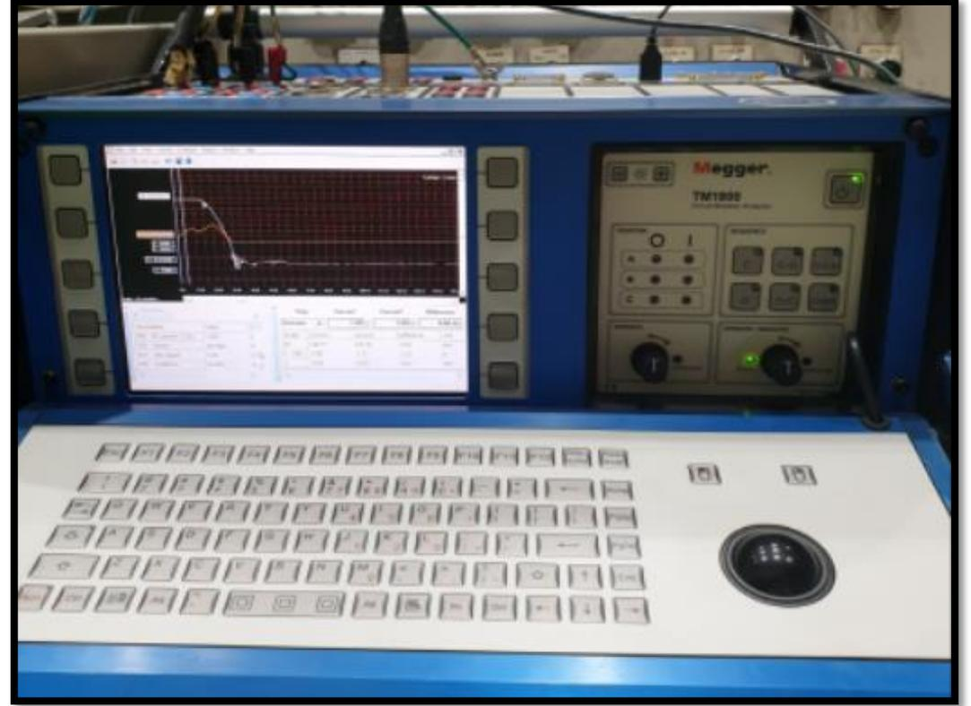
조작기에 Sensor 설치 → 동작속도 측정 → 조건에 따른 속도 변화 분석
