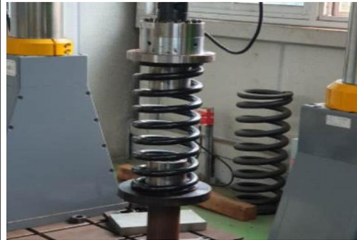
유압피로시험기를 이용한 스프링 강성계수 측정
